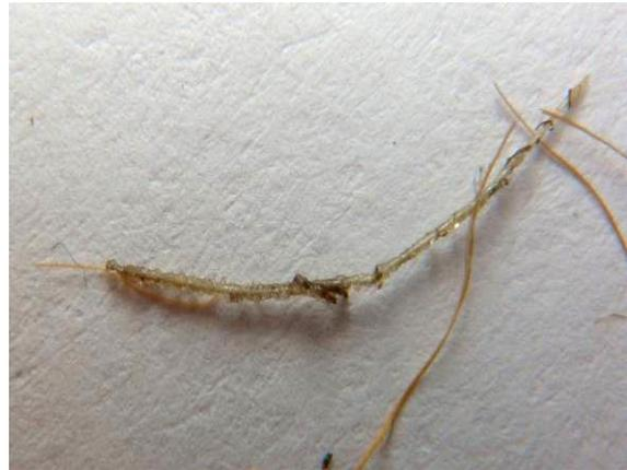
**Figura 23.** Frammento di filo vetrificato dalla copertura con la resina consolidante
