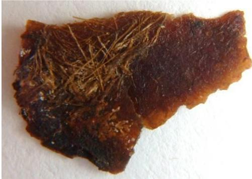
**Figura 15.** Frammento di colore che appare traslucido per la presenza della glicerina (verso). Si notano anche fili del tessuto di supporto molto grezzo.
